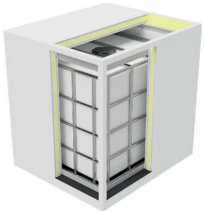
Bild 7. Planungsskizze des Eisspeicher-Demonstrators Foto: RWTH Aachen Fig. 7. Conceptual sketch of the ice storage demonstrator Source: RWTH Aachen
