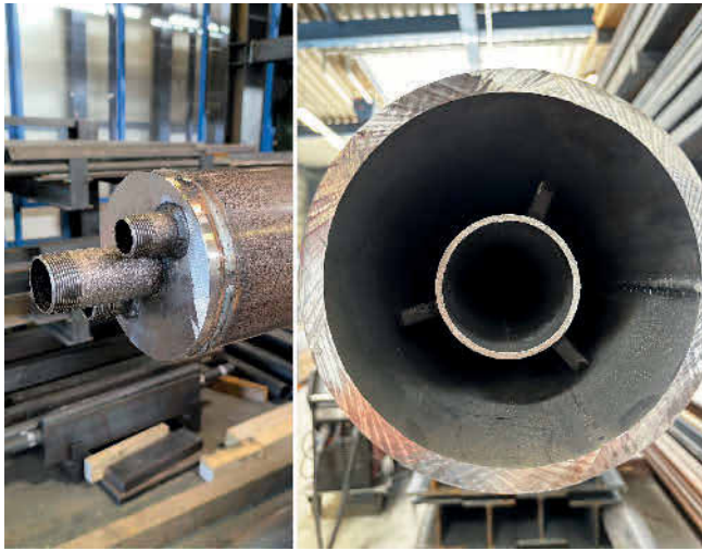
Bild 1. Stahl-Energiepfahl-Demonstrator für den Feldversuch (links: Sondenkopf nach dem Schweißen, rechts: Sondenfuß vor dem Schweißen, koaxiale Ausführung) Foto: RWTH Aachen Fig. 1. Steel Energy Pile Demonstrator for the field test (left: probe head after welding; right: probe base before welding, coaxial design) Source: RWTH Aachen
