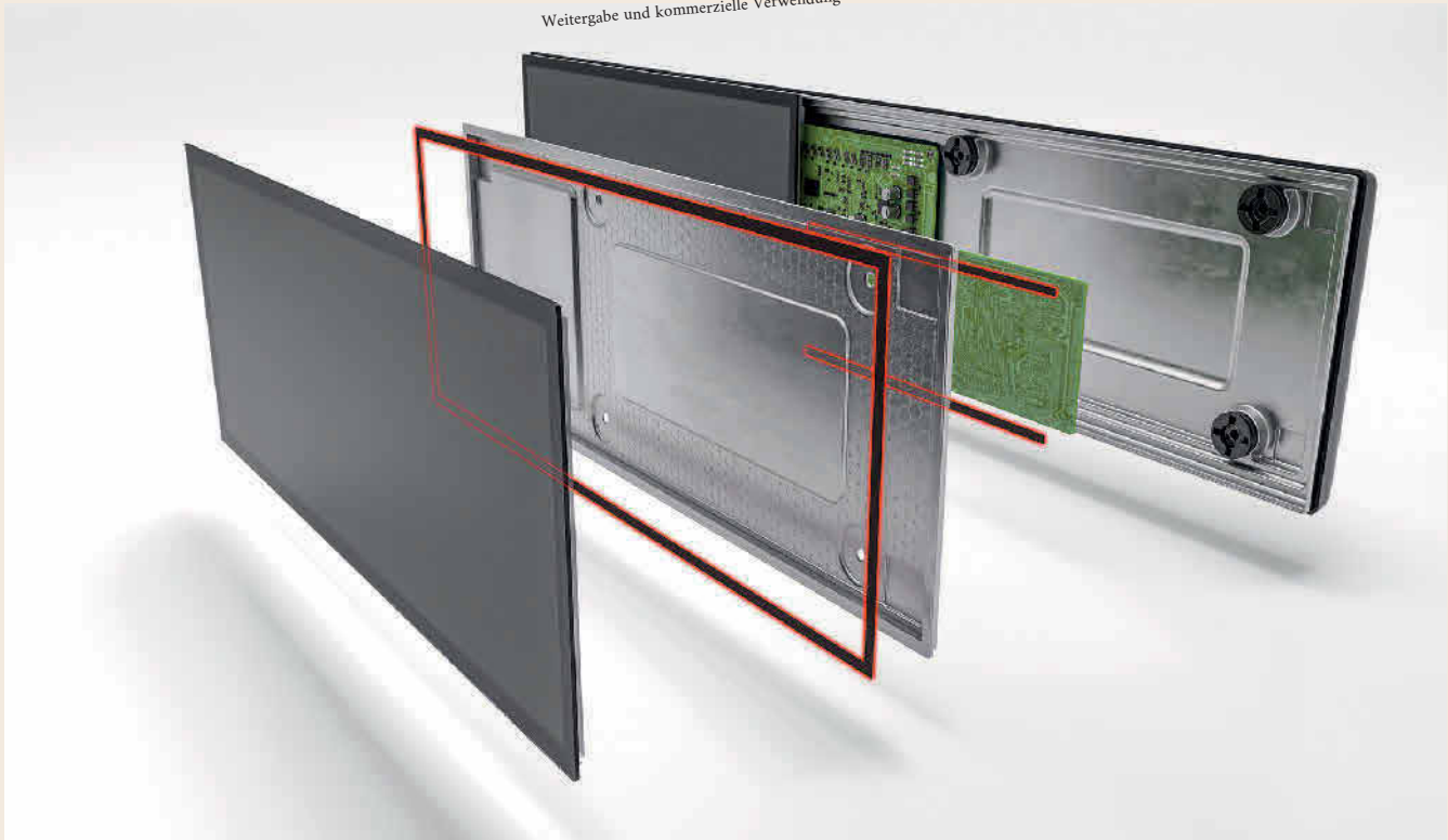
Bild 1 Die kontrollierte Ablösung einzelner Komponenten am Ende der Produktlebenszeit erleichtert sortenreine Recyclingprozesse und unterstützt so Kreislaufwirtschaft. Foto: AUMOVIO
