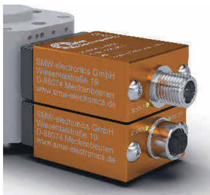
Bild 3: Das kontaktlos arbeitende induktive Kopplersystem C40 Automation macht die Medien- und Signalübergabe unempfindlich gegen Verschmutzungen. Bild: SMW-Electronics
