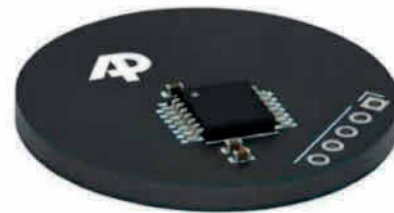
Bild 2: Sehr dünner Kraftsensor zum Erfassen der elastischen Verformung. Bild: Angst+Pfister
