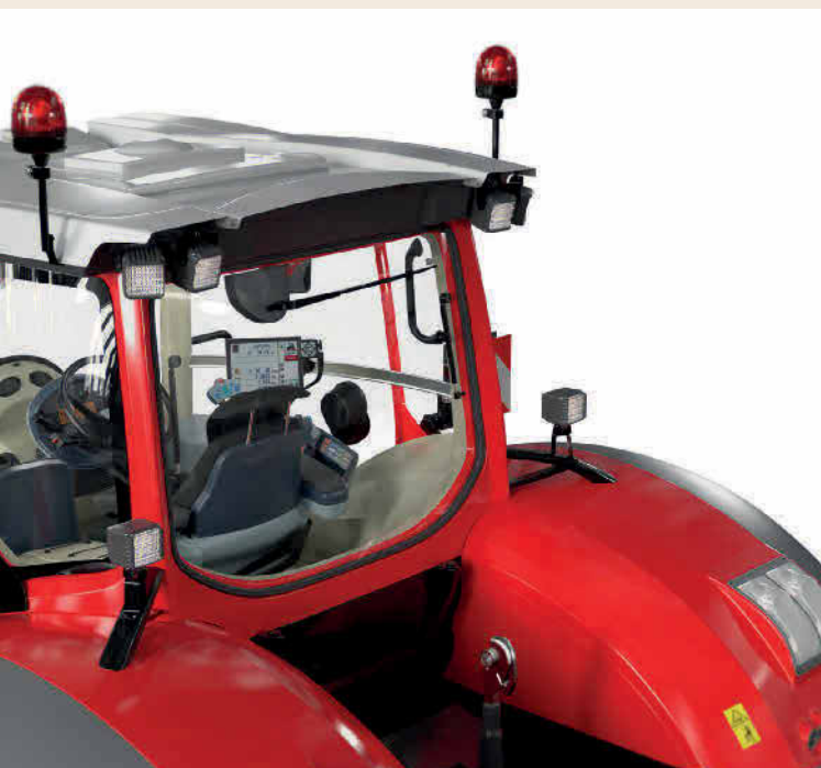
Verbesserte, silanmodifizierte Polymer-Klebe- und Dichtstoffe können für zahlreiche Anwendungen eingesetzt werden, darunter die Verglasung von Fahrerinnen, die Verkleidung der Seitenwände und die Verklebung der Dachhaut bei Fahrzeugen sowie die Abdichtung von Nähten und Fugen.
