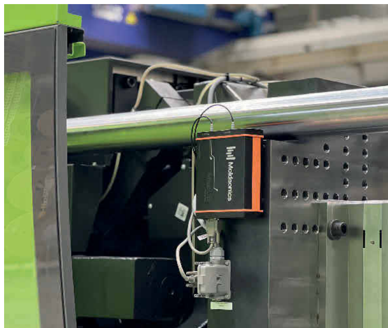
Ultraschallbasierte Inline-Sensorplattform für Kunststoffprozesse. Bild: Moldsonics
