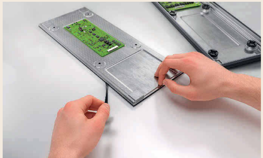
Bild 3 Eine kontrollierte, bei Bedarf lösbare Klebeverbindung lässt Korrekturen während der Produktion und Reparaturen über den gesamten Produktlebenszyklus zu. Foto: AUMOVIO
