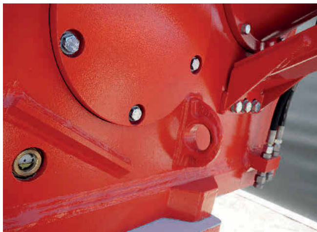
Bild 3: Allseitig belastbare schweißbare Anschlag- und Zurrpunkte der Typen W-ABA (li.) oder L-ABA (re.) werden vollflächig mit umlaufender Kehlnaht verschweißt. Sie verfügen über geprüfte Tragfähigkeiten oder definierte Zurrkräfte. Bild: RUD
