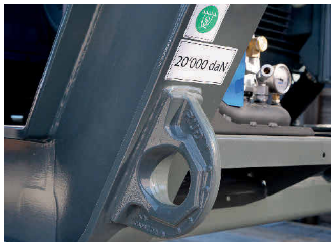
Bild 3: Allseitig belastbare schweißbare Anschlag- und Zurrpunkte der Typen W-ABA (li.) oder L-ABA (re.) werden vollflächig mit umlaufender Kehlnaht verschweißt. Sie verfügen über geprüfte Tragfähigkeiten oder definierte Zurrkräfte. Bild: RUD
