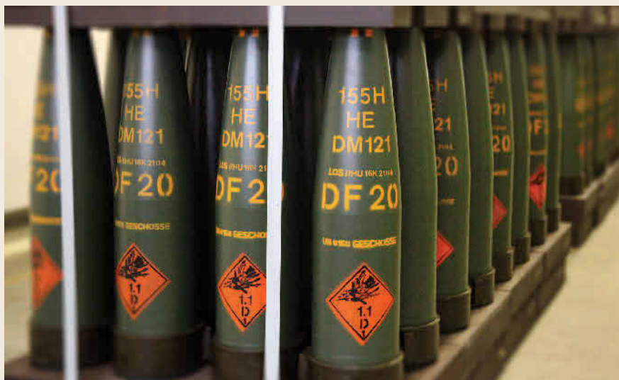
Bild 4 Aus Stabstahl der Güte 42CrMo4 von Saarstahl wird das Vorprodukt für die Hülle des NATO-Geschosses 155 mm Großkaliber hergestellt. Foto: Rheinmetall
