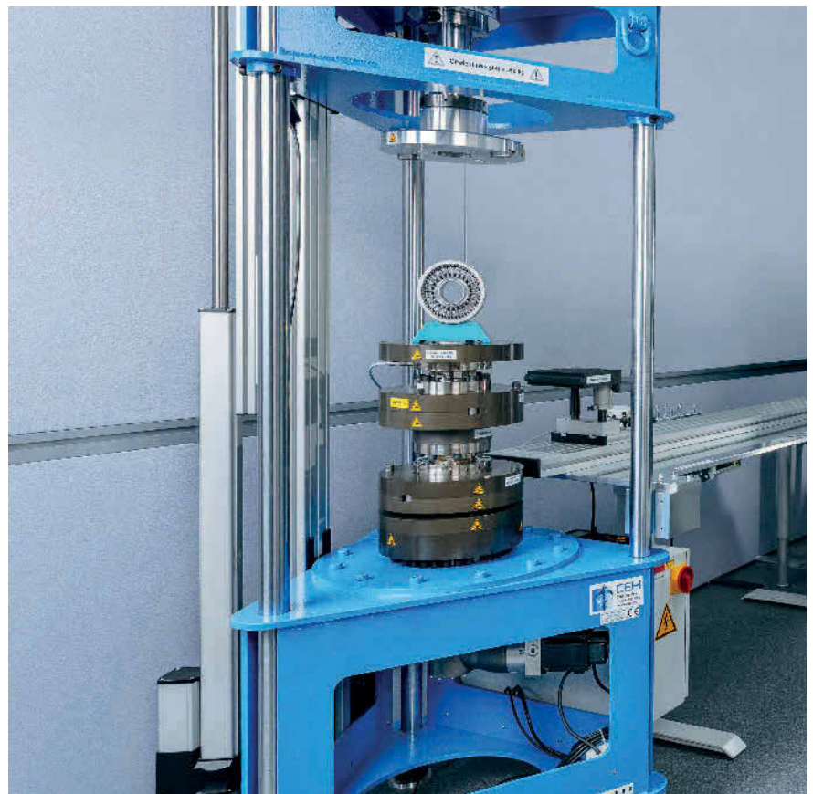
Bild 1: Die CEH-Kalibriereinrichtung ist aktuell in der Calibration Factory von Testo Industrial Services im Einsatz, wo sie für akkreditierte Kalibrierdienstleistungen und Kundenprojekte genutzt wird. Bild: Wittenstein
