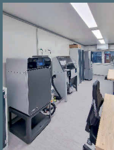
Containerlösung: Drucker, Aufbereitungsanlage und Peripherie sind in einem Allwettercontainer zusammengefasst, der wie eine Spritzgussmaschine verwaltet wird – inklusive Anbindung an das ERP-System. Bild: Tsubaki Kabelschlepp
