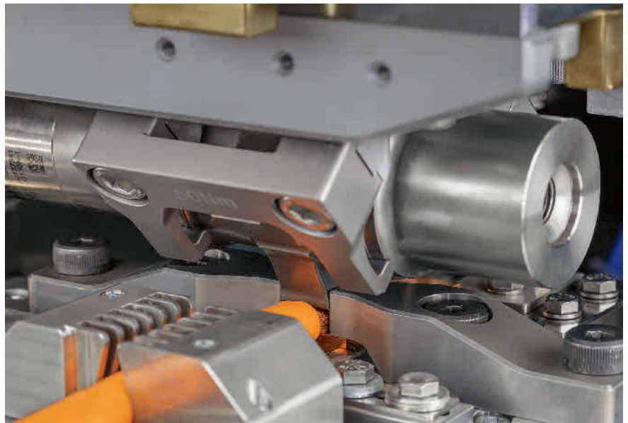
Bild 3: Die Power-Wheel-Technik bringt die Schweißkraft punktgenau ein. Bild: Telsonic
