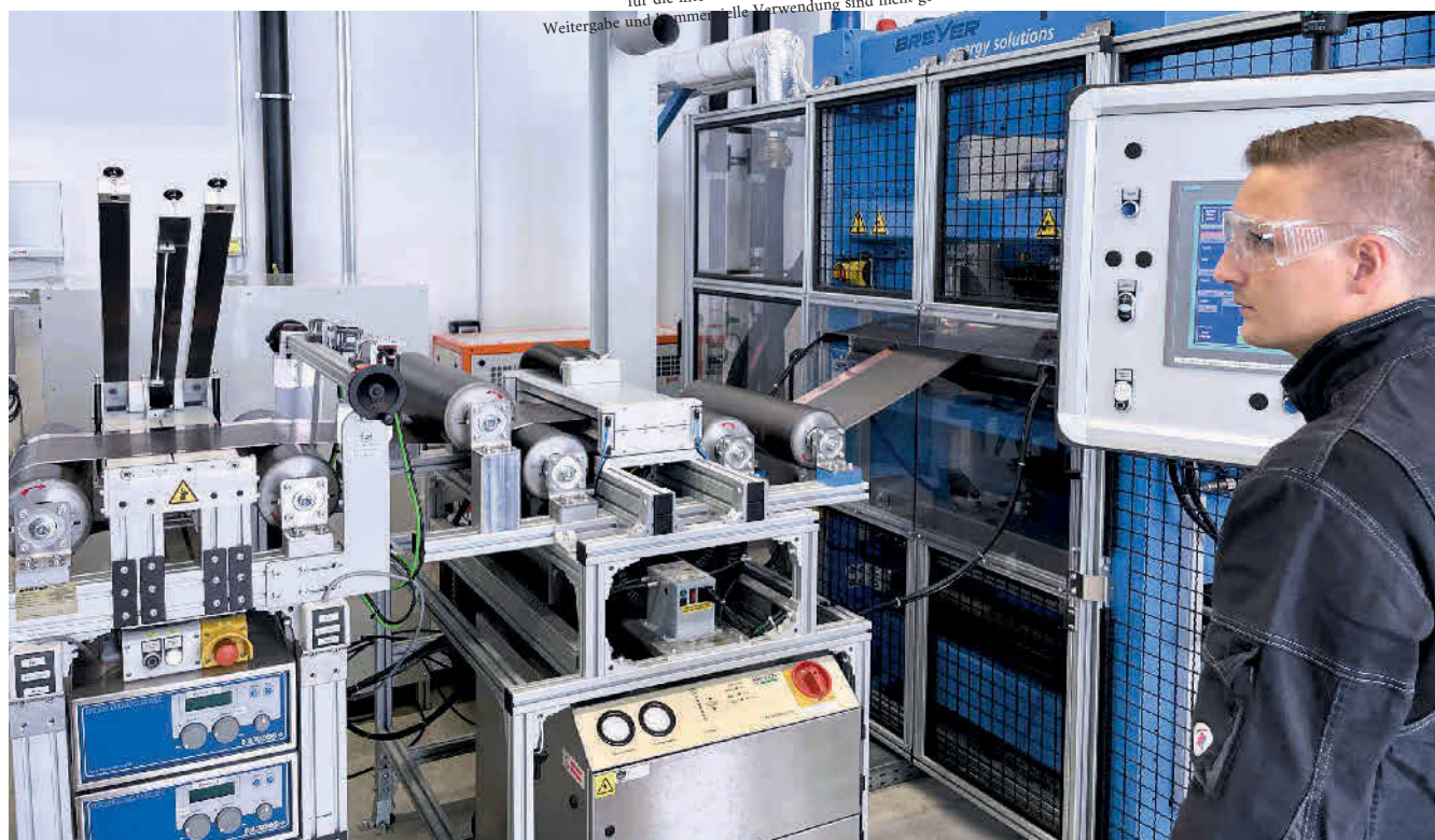
Forscher des ZSW fertigt Elektroden in der Forschungsproduktionsanlage: Im Projekt Medicell entwickeln sie wiederaufladbare Spezialbatterien für tragbare Medizintechnik. Bild: ZSW
