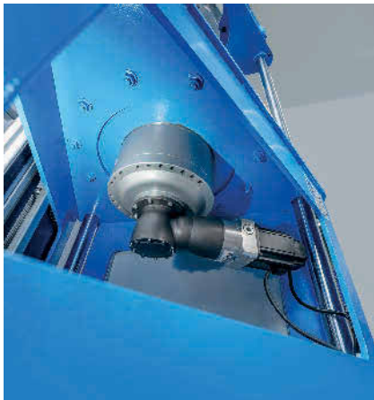
Bild 2: Das Winkelgetriebe Galaxie GH 175 ist in die Kalibriervorrichtung integriert, durch die die Drehmomentaufnehmer mit den definierten Laststufen beaufschlagt werden. Bild: Wittenstein
