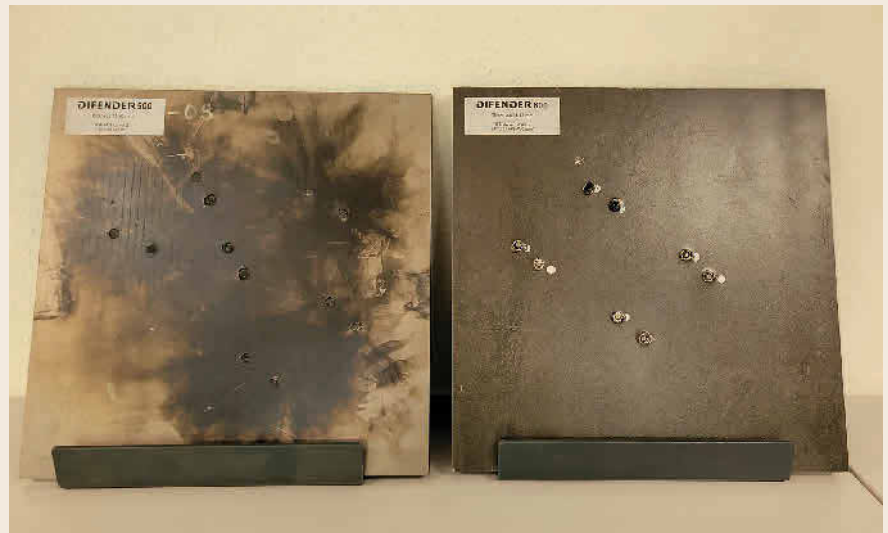
Bild 2 Ballistische Prüfung: Difender Sicherheitsstähle zählen bei Beschuss und Anspregung laut Dillinger zu den sichersten am Markt. Foto: Dillinger
