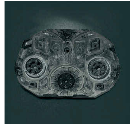
Bild 3: Beim 3D-Scanning werden erste Muster vollständig gescannt und automatisch mit den CAD-Solldaten verglichen. Bild: Tsubaki Kabelschlepp
