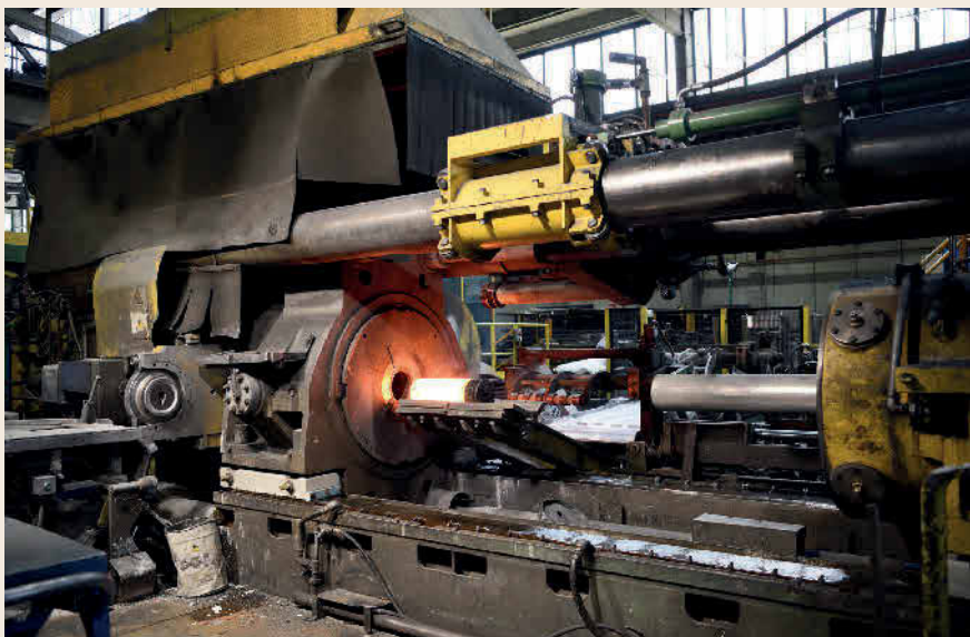
Bild 5 Produktion von Edelstahlprofilen, die zur geforderten Sicherheit der Flugzeuge beitragen, zum Beispiel als Befestigungselemente oder hitzefeste Strukturbauteile. Foto: Montanstahl
