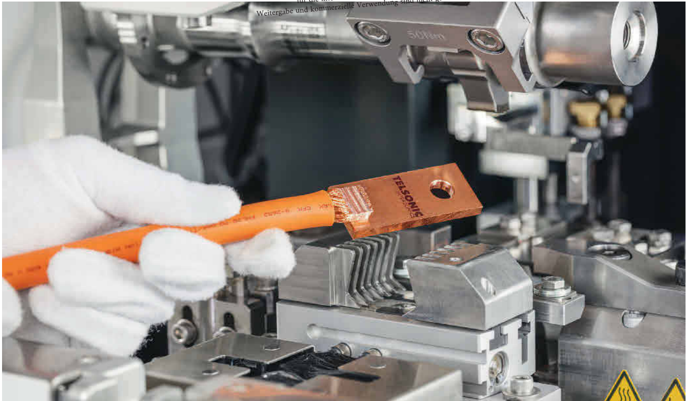
Bild 1: Die neue DIN 72036 ermöglicht den Übergang von der manuellen Leitungssatzfertigung zur automatisierten Fertigung. Bild: Telsonic
