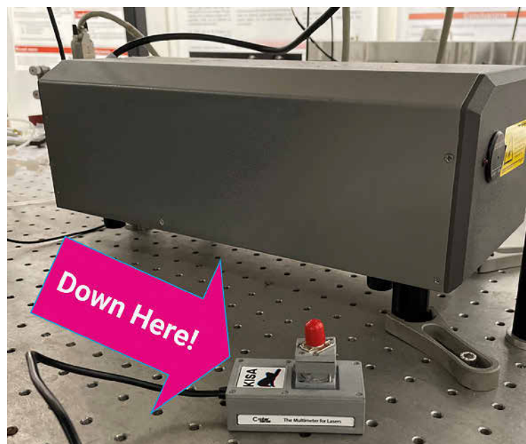
Vergleich zwischen einem typischen Laborsystem und dem Kisa (Kompakt Interferometer für Spektrale Anwendungen). Bild: Coher Sense
