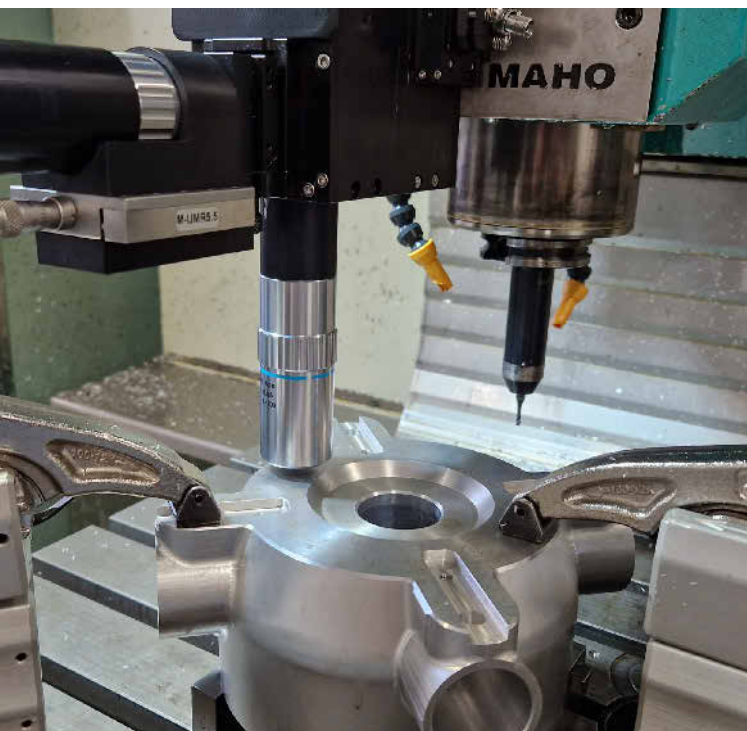
Bei der vibrationsimmunen Inline-Weißlichtinterferometrie erfasst ein interferometrischer Distanzsensor die Relativbewegung zwischen Messsystem und Bauteil in Echtzeit. Bild: Metubiq
