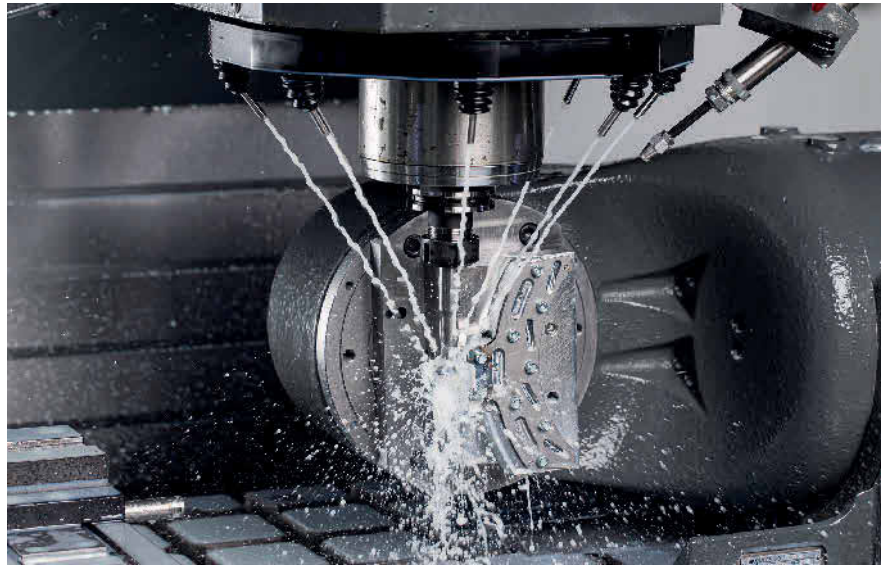
Bild 2. Asch & Sebert hat einen Kühlmittelring entwickelt, bei dem sich die Kühlmitteldüsen automatisch der Werkzeuglänge anpassen. Die Düsen liefern einen Kühlmitteldruck von maximal 15 bar. Foto: Horn/Sauermann
