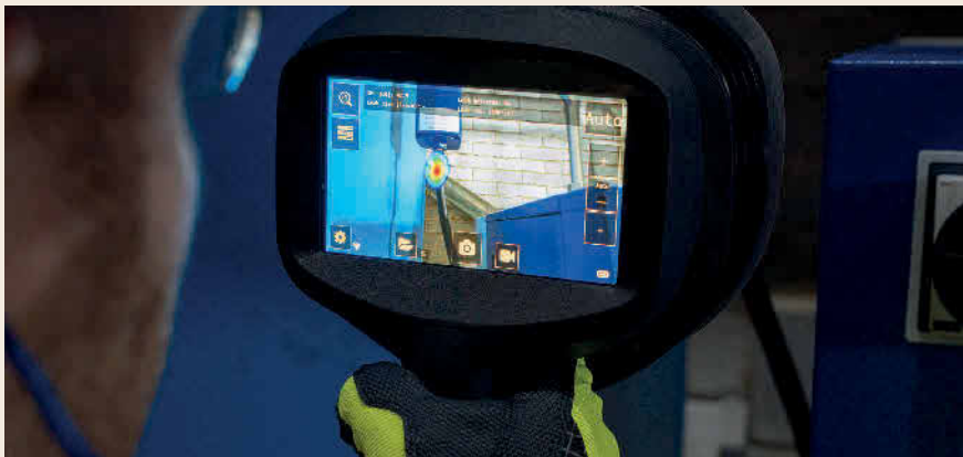
Bild 1. Sichtbar wird auch das Ausmaß der Leckage. Foto: FLIR Systems/Teledyne
