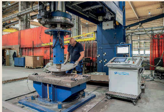
Bild 2. Ein Worker bei der Bearbeitung eines Probestücks. Dank des Messsystems kann bei der Umformung auf den Einsatz von Prüfschablonen verzichtet werden. Foto: Fraunhofer IOF
