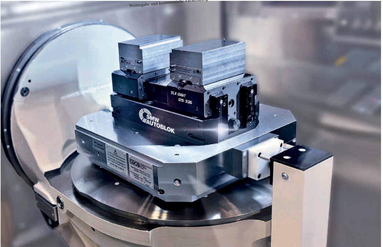
In der Werkstückbearbeitung erlaubt der Langhubspanner „SLX digit“ eine hohe Variantenvielfalt mit wenigen Spannmittelwechseln. Die Backen können per Roboter gewechselt werden. Foto: Grob-Werke
