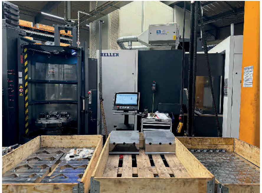
Bild 1. An den FPT-1000 ist ein horizontales 5-Achsbearbeitungszentrum angekoppelt. Auf einer Stellfläche von nur 19 m 2 lassen sich zwölf bis 24 Paletten in zwei unterschiedlichen Höhen aufnehmen.
