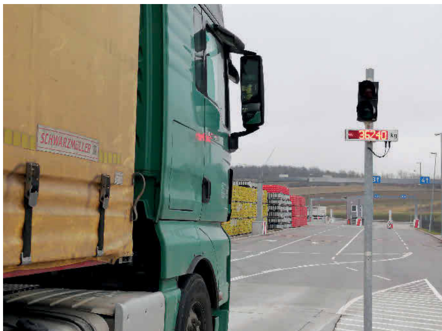
Bild 3. Die Software übernimmt die operative Steuerung des gesamten Lkw-Durchlaufs, von der Einfahrt ins Werk über das Wiegen bis hin zur Be- oder Entladung an der Rampe. Foto: Inform
