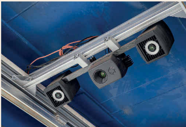
Bild 1. Zwei synchronisierte Kameras und ein Projektor zur Musterprojektion: Diese Konfiguration wird auf beiden Seiten des Werkstücks positioniert. Foto: Fraunhofer IOF
