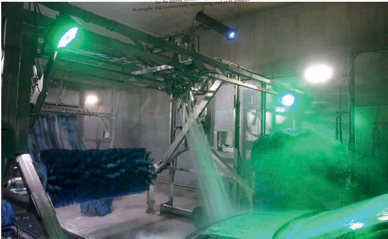
Nasse Umgebung: In einer Waschstraße bewegen sich schwere Bauteile hochdynamisch. Gute Stoßdämpfer sind unverzichtbar. Foto: MTE GmbH
