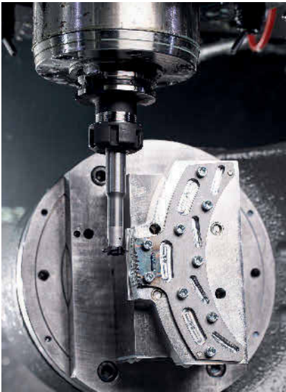
Bild 1. Durch den schwingungsdämpfenden Vollhartmetallschaft treten trotz der langen Auskragung keine Probleme mit Vibrationen des Werkzeugs auf. Foto: Horn/Sauermann
