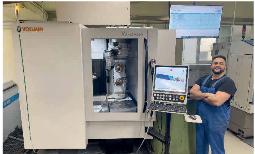
Bild 1. Die „VGrind argon“ bearbeitet Rotationswerkzeuge bei Kock. Der automatische Schleifscheibenwechsler sorgt für hohe Produktivität. Foto: Vollmer
