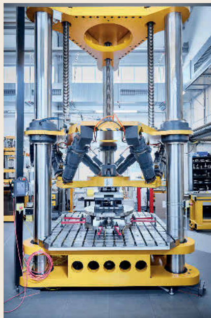
Bild 2. Die von GTM entwickelte und akkreditierte Mehrkomponenten-Bezugsnormalmessenrichtung zur Kalibrierung von MKA kann alle Vektorachsen gleichzeitig erfassen und bezieht auch die Schwerkraft ein. Foto: GTM
