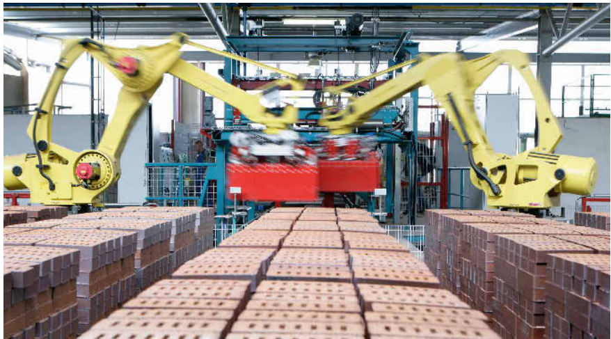
In der Janinhoff-Klinkermanufaktur in Münster werden Ziegel effizienter und mit weniger THG-Emissionen hergestellt. Schrittweise soll zudem Erdgas durch Wasserstoff ersetzt werden. Hier übernimmt Robotertechnik in der Absetzanlage das Abladen gebrannter Ziegel. Foto: P. Wattendorf
