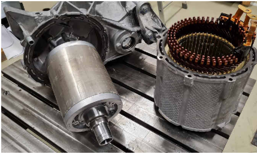
Getriebe mit Rotor (links) und demontierter Stator im Hairpin-Design mit Kupferwicklung (rechts). Foto: Fraunhofer IWU
