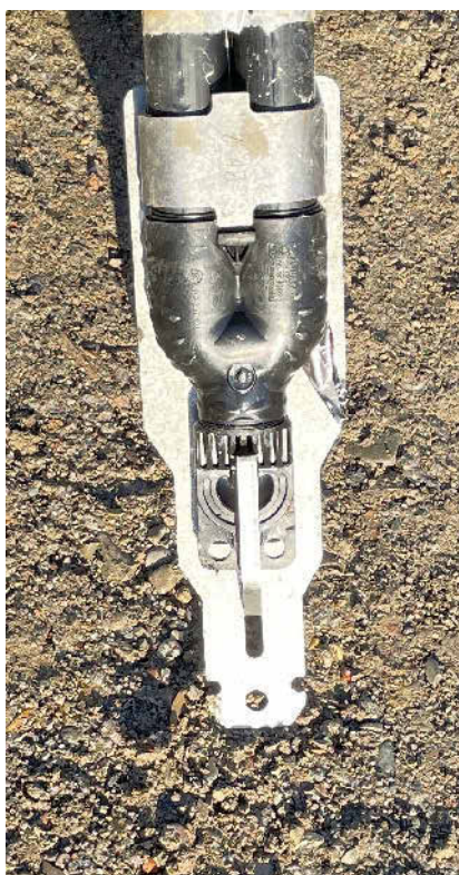
Eine der 25 Erdwärmesonden , die mit einem horizontalen Abstand von etwa 8 m in 240 m Tiefe platziert wurden. Dort herrscht eine Quelltemperatur von 17 °C. Im Sommer wird die überschüssige Wärme aus dem Gebäude verwendet, um die Umgebung der Erdsonden in der Tiefe zu regenerieren beziehungsweise zu erwärmen. Foto: Carderie
