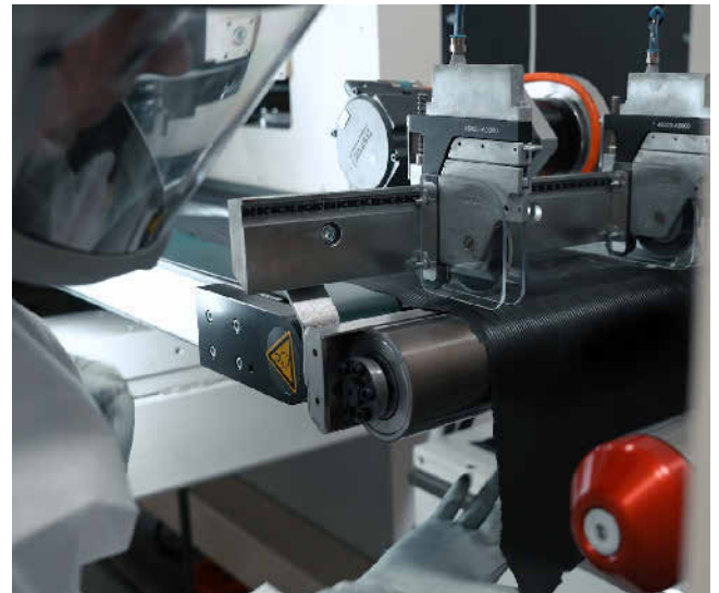
Der erste Schritt in der „X.Cellify DC“-Anlage aus Baden-Württemberg ist die Filmbildung. Aus einem trocken angemischten Pulver wird dabei ein freistehender Aktivmaterialfilm gebildet. Foto: Dürr Systems
