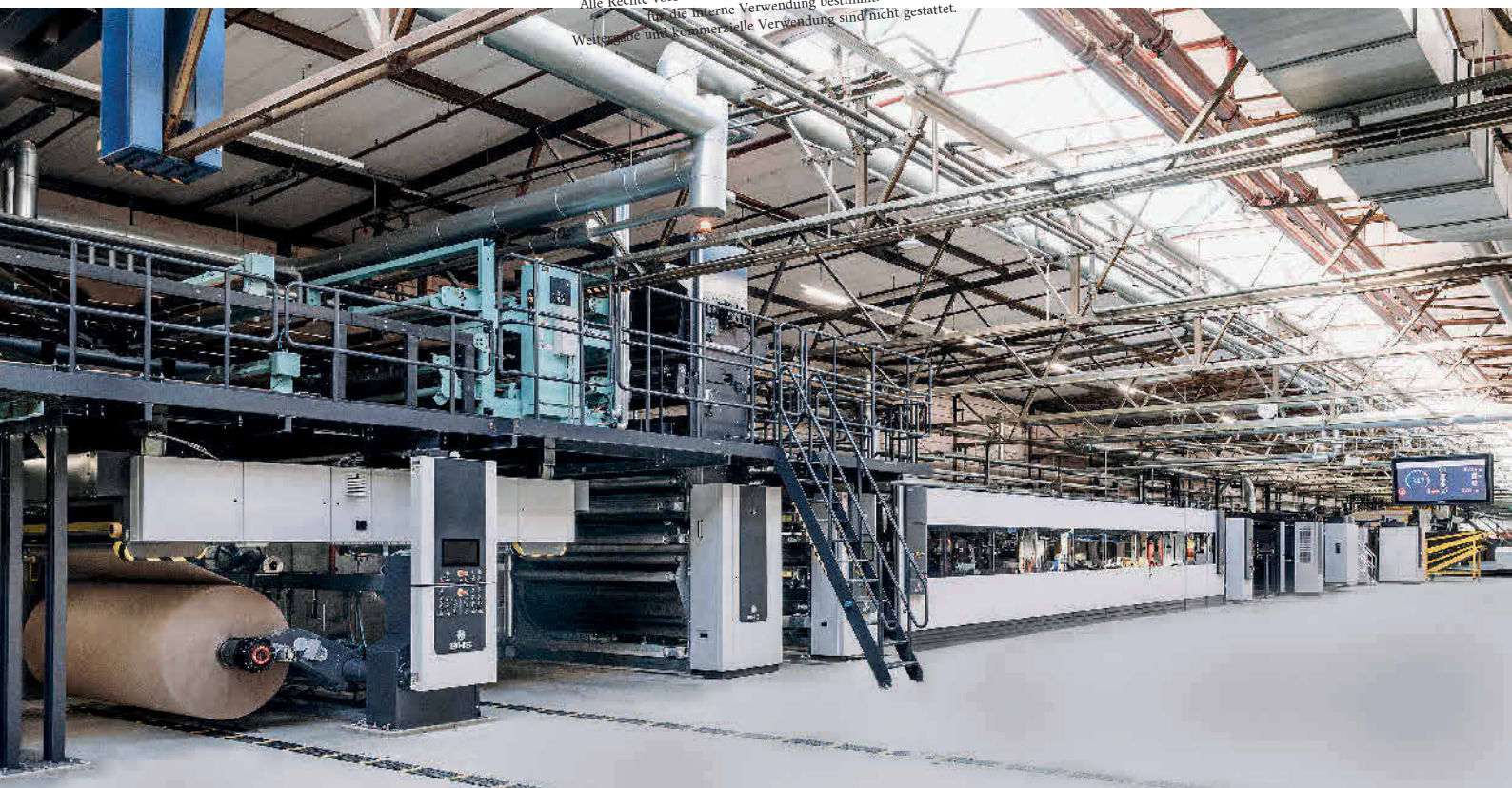
Bild 1 Die gigantischen Wellpappenanlagen von BHS Corrugated können bis zu 200 m lang sein. Foto: BHS Corrugated
