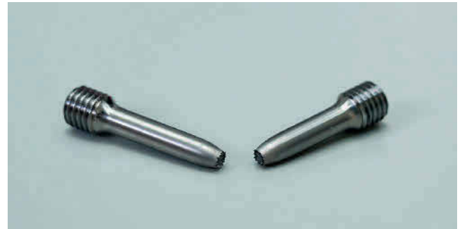
Bild 2 Metallische Hohlprobe unter Druckwasserstoff bis 1.000 bar. Foto: ZwickRoell
