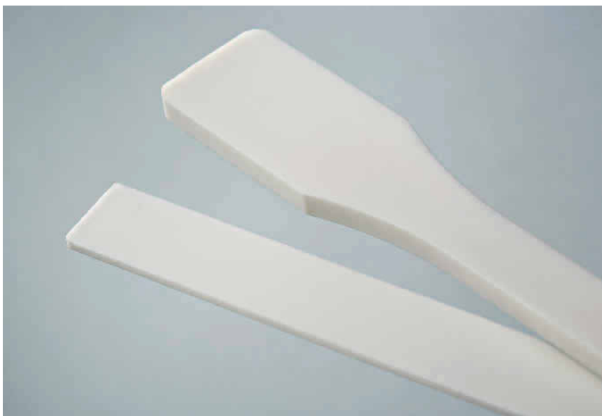
Bild 1 Langzeiteigenschaften von Kunststoffen: Nach 15 Jahren bleibt die Schwingfestigkeit stabil bzw. leicht verbessert, Additive und Stabilisatoren wirken weiter. Foto: Fraunhofer LBF
