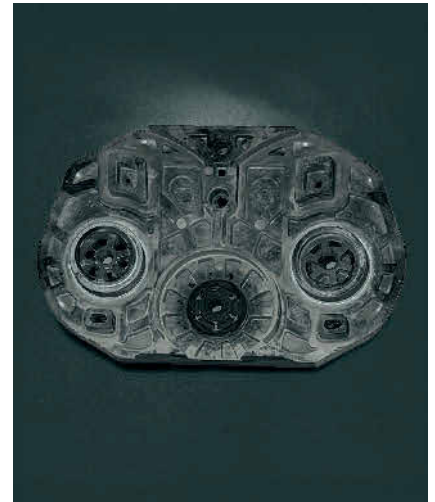
Bild 3 Entwicklungsbeschleuniger 3D-Scanning: Statt jede Optimierungsstufe mit aufwendigen taktilen Messreihen zu verifizieren, können erste Muster vollständig gescannt und automatisch mit den CAD-Sollgeometrien abgeglichen werden. Foto: Tsubaki Kabelschlepp
