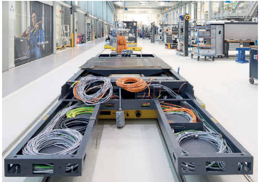
Bild 2 Die einzelnen Anlagenteile werden bei BHS Corrugated zusammengebaut und anschließend zum Kunden transportiert – erst dort erfolgt die Endmontage. Foto: Helukabel
