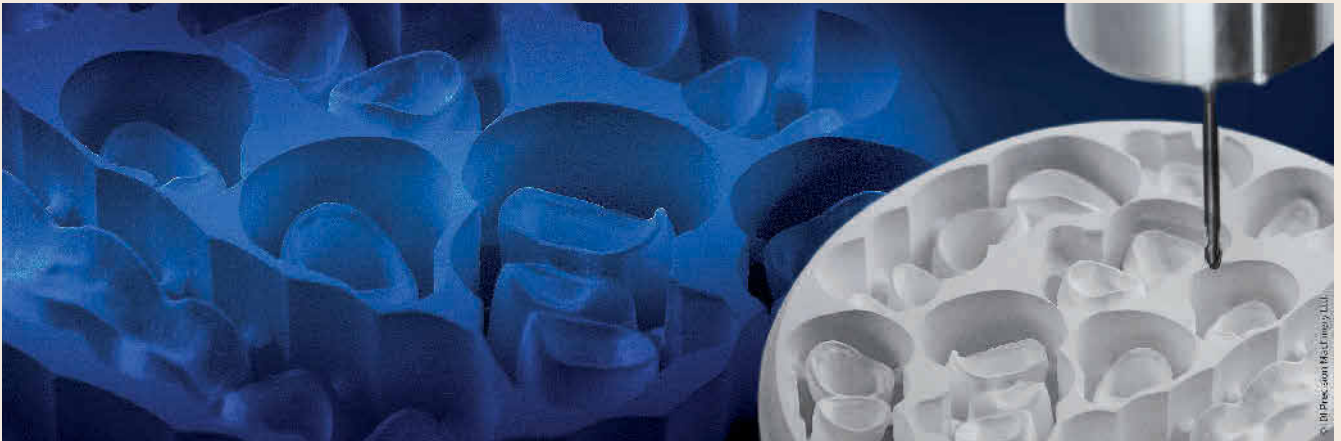
Bild 2 Zahnersatz in Rekordzeit – direkt aus der CAD/CAM-Fräseinheit statt aufwendig im Labor gefertigt: Die aktuellen Entwicklungen in der Dentaltechnik eröffnen innovative Möglichkeiten. Foto: IDI_Precision_Machinery_Ltd
