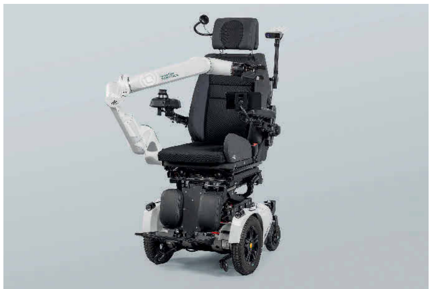
Bild 3 DLR Roboter auf Basis eines Elektrorollstuhls, erweitert um einen sensitiven Roboterarm und eine KI-gestützte Steuerung. Foto: DLR (CC BY-NC-Nd 3.0)
