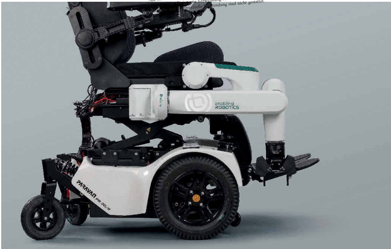
Bild 1 Senso-Joints von Sensodrive im KI-Assistenzroboter für Menschen mit Mobilitätseinschränkung. Foto: DLR CC BY-NC-Nd 3.0)
