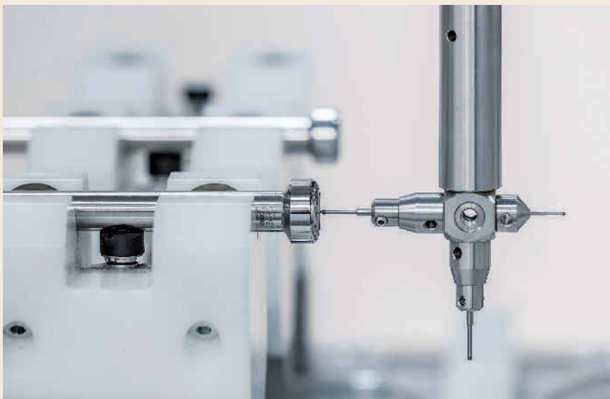
Bild 5 In Tablettieranlagen bieten Komponenten aus Edelstahl Rostfrei –wie diese Messmaschine –zuverlässigen Schutz vor Emissionen und Kreuzkontamination. Foto: FETTE Compacting
