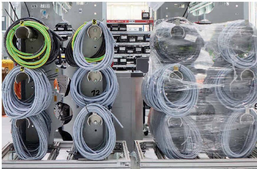
Bild 4 Die Leitungen werden zugeschnitten, mit den passenden Steckverbindern und vorsortiert in die Montage geliefert. Foto: Helukabel
