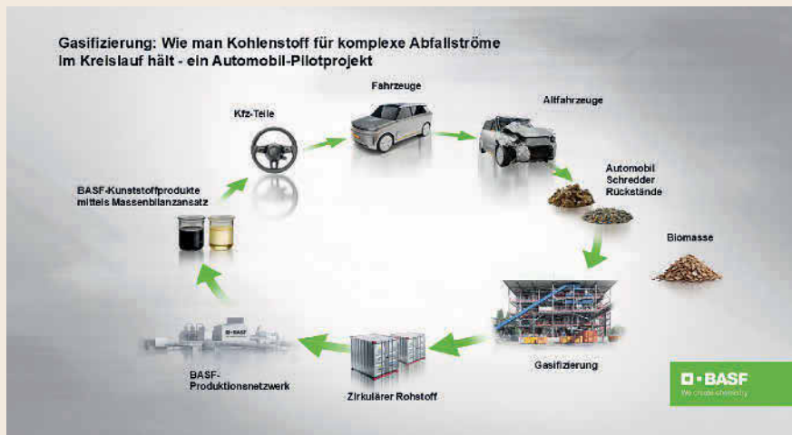
Bild 2 Die Porsche AG und die BASF SE haben in Zusammenarbeit mit dem Technologiepartner BEST – Bioenergy and Sustainable Technologies GmbH ein Pilotprojekt zum Recycling von gemischten Abfällen aus Altfahrzeugen erfolgreich abgeschlossen. Grafik: BASF SE
