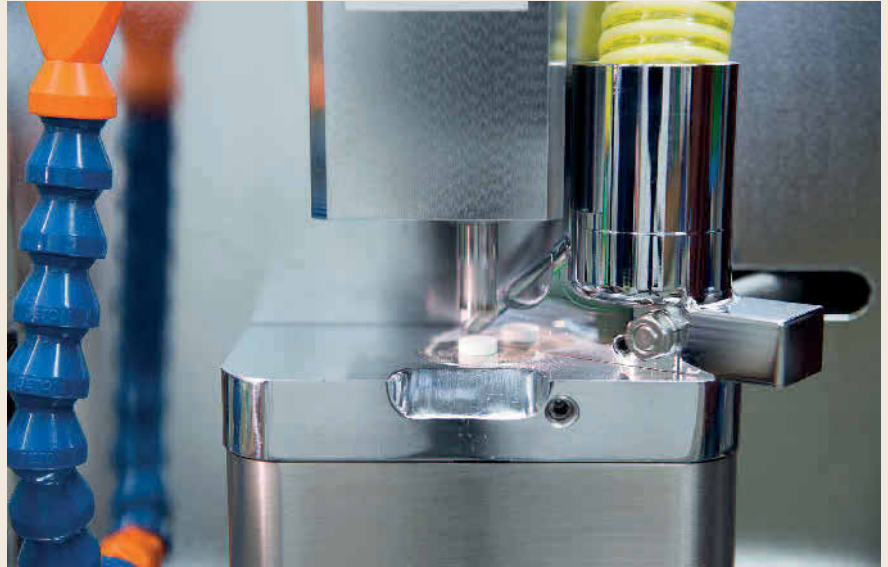
Bild 2 Edelstahl Rostfrei ist aufgrund seiner Korrosionsbeständigkeit und guten Verarbeitungseigenschaften ein Standardwerkstoff für zahlreiche Bauteile in Tabletieranlagen. Foto: WZV/ERWEKA
