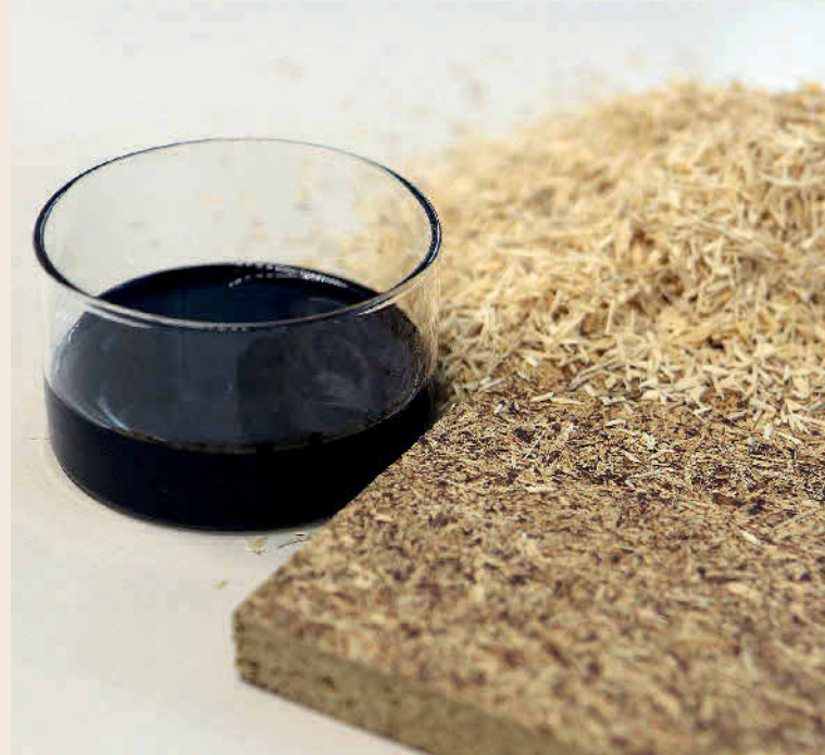
Zutaten für die Spanplatte der Zukunft: Biogenes, formaldehydfreies Lignin-HMF-Kondensationsharz und alternative Holzarten aus klimaresilienten Mischwäldern. Foto: Fraunhofer WKI/Manuela Lingnau
