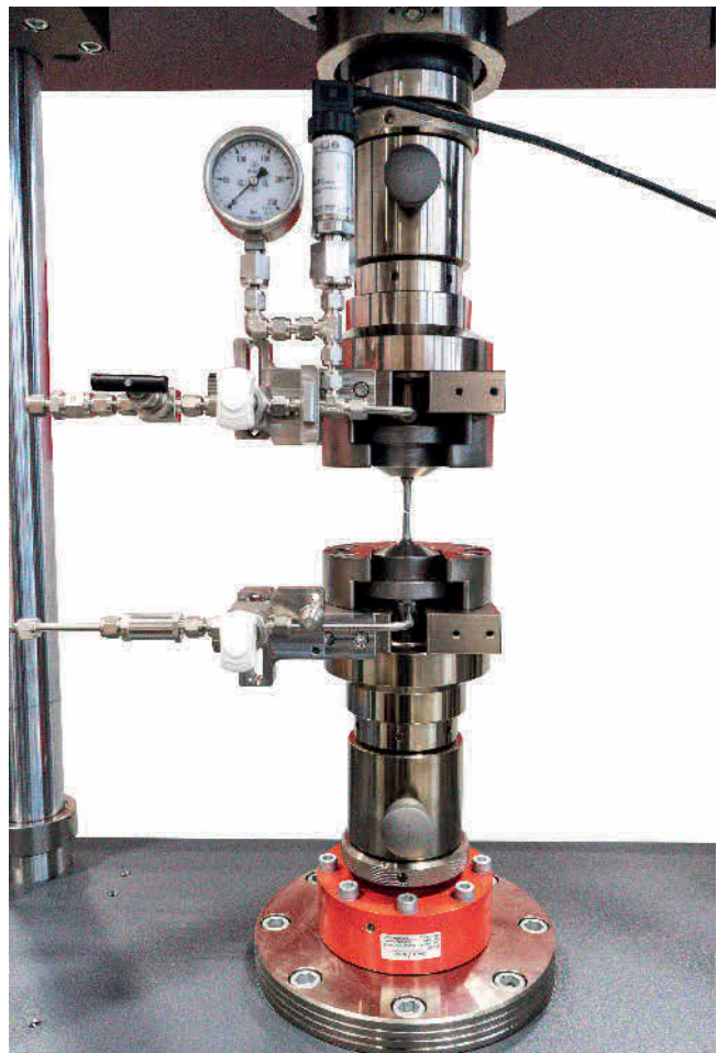
Bild 1 Detailaufnahme eines Prüfsystems zum Prüfen metallischer Hohlproben unter Druckwasserstoff. Foto: ZwickRoell
